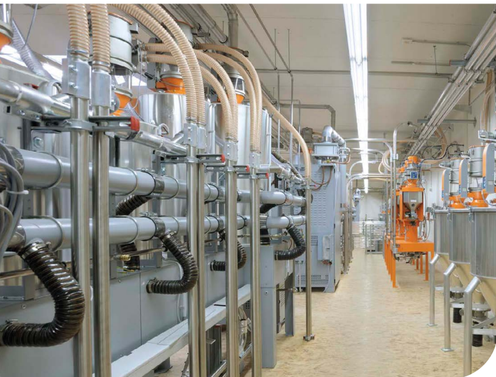
Absaug- und Förderschläuche zum Befüllen der Granulattrockner sowie temperaturbeständige Schläuche zum Fördern der Trocknungsluft
