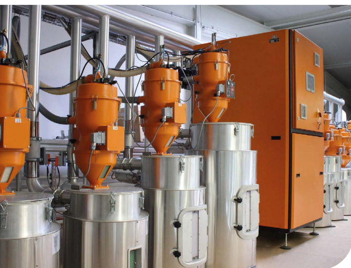
Absaug- und Förderschläuche zum Befüllen der Granulattrockner sowie temperaturbeständige Schläuche zum Fördern der Trocknungsluft
